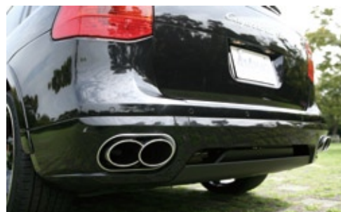
リアマフラーは左右4本出し。テールパイプを追加すれば、さらなる排気効率向上を図ることができる。
