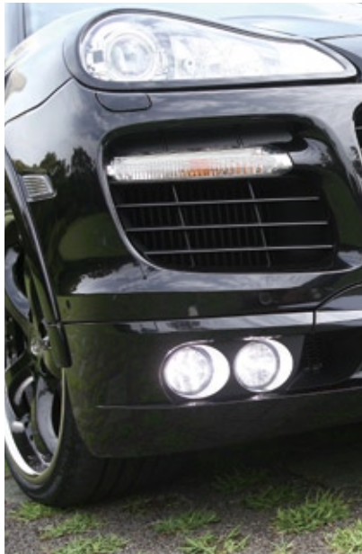
補助ランプが2灯、ビルトインされたフロントスポイラーがグリル下に装着される。
