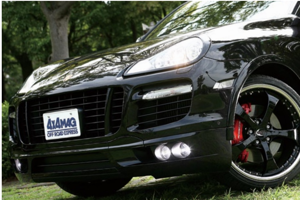
補助ランプが2灯、ビルトインされたフロントスポイラーがグリル下に装着される。
