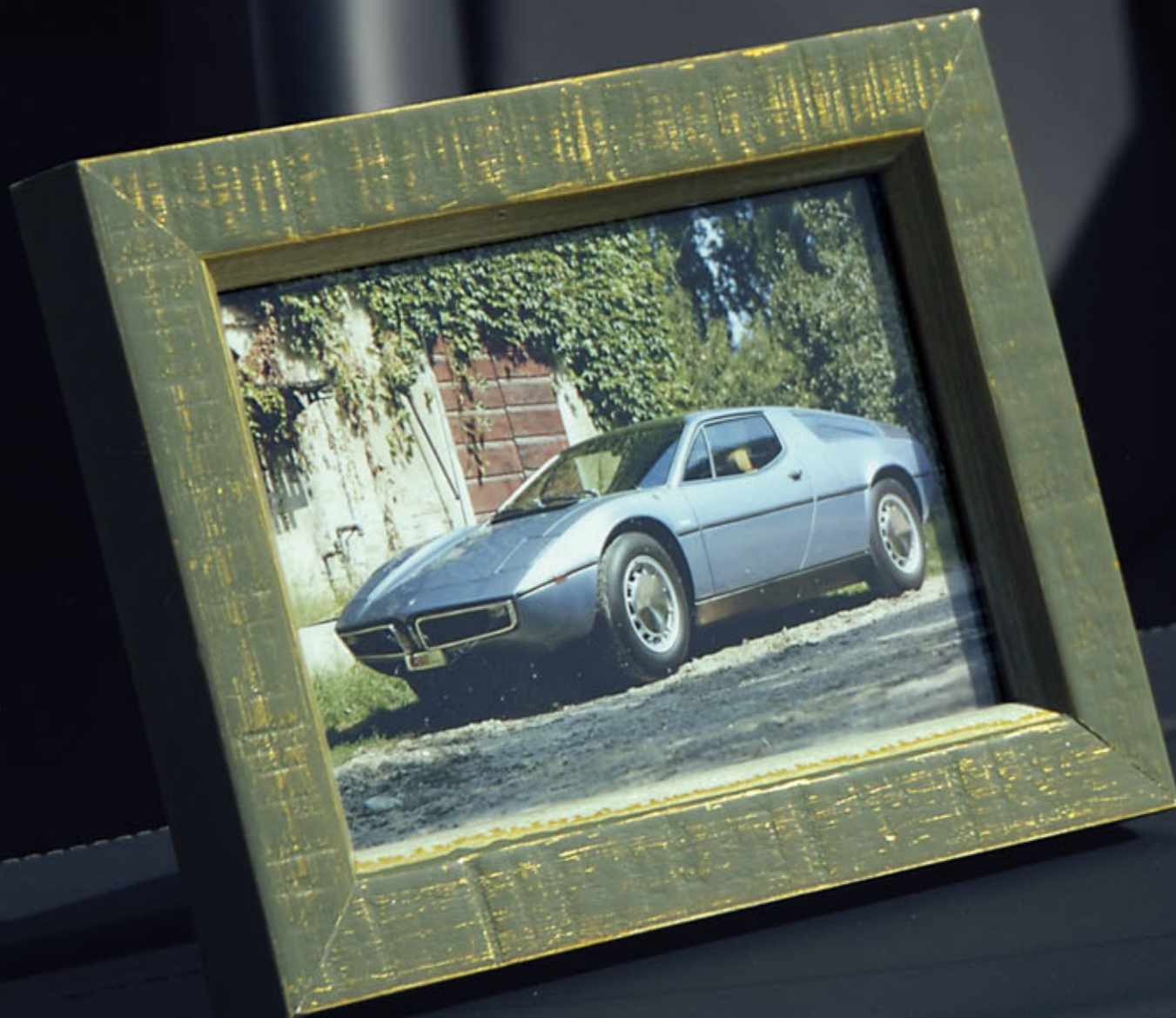
マセラティ・ポーラ(1972)_90度V型8気筒DOHC ミッドシップ縦置 93.9×85.0mm 4719cc 8.5:1 310ps/6000rpm 47.0mkg/4200rpm 5段MT 4335×1770×1135mm W/B 2600mm 1400kg
