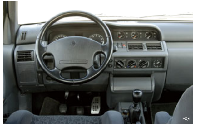
運転席にエアバッグが備わる1996年式の16V。空調吹き出し口の上に並ぶ3連メーターは左から、油量計／油温計／油圧計。油温計の針だけオレンジ色なのは、フェイス1の中古パーツを流用したからだろう。
