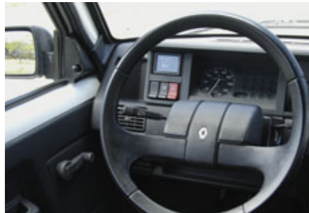
水温計もレヴカウンターもなく、スピードメーターとガソリンメーターのみ配置された、簡素なメーターナセル。
