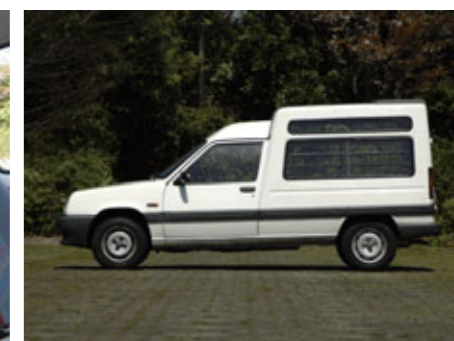
全長×全幅×全高 3990×1575×1790mm、車重840kg。1.4ℓ直4OHVユニットから60ps/10.4mkgを発生。
