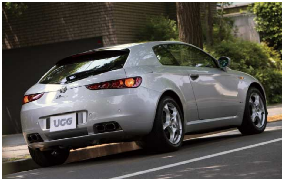
2006年春に上陸を果たしたアルファ・ブレラ。試乗車に搭載される2.2ℓ直4ユニット(185ps/23.5mkg)の他に、3.2ℓV6(260ps/32.8mkg)も用意されている。後者は4WDが採用され、6段MTの他、今年の3月にはQトロニックと呼ばれる6段ATも追加設定された(2.2ℓは6段MTのみ)。全長4415×全幅1830×全高1365mm。車両協力：アルファ・ロメオ田園調布アップロードカーセンター(06年式 アルファ・ブレラ・スカイウィンドー2.2JTS 走行4000km 価格399万円) Tel.03-3721-1565
