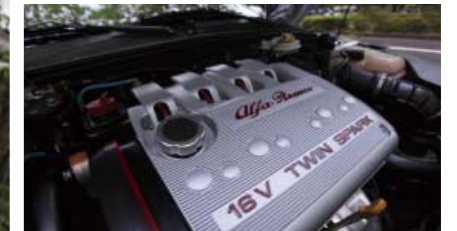
試乗車はGTVが最後に採用したパワーユニットとなった2ℓ直4ツインスパーク(150ps/6300rpm、18.4mkg/3800rpm)搭載。5段MTを介して前輪を駆動する。全長4295×全幅1780×全高1320mm。車重は1350kg。車両協力=コレツィオーネ世田谷店(04年式 アルファGTV 2.0TS 走行2.4万km 価格248万円) Tel.03-5758-7007
