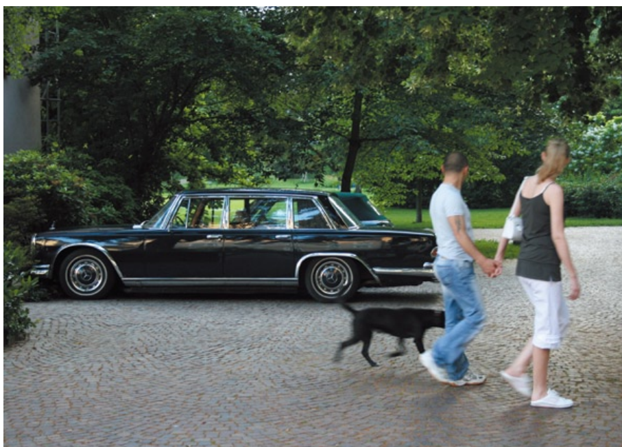
メルセデス600は、1963年にデビュー。V型8気筒エンジンは6332cc 250HP。1981年までに生産された台数は約2500とも2600台ともいわれる。写真の5.5m仕様のほか、さらなるロングバージョン「ブルマン」もあった。バーデン・バーデンにて。
