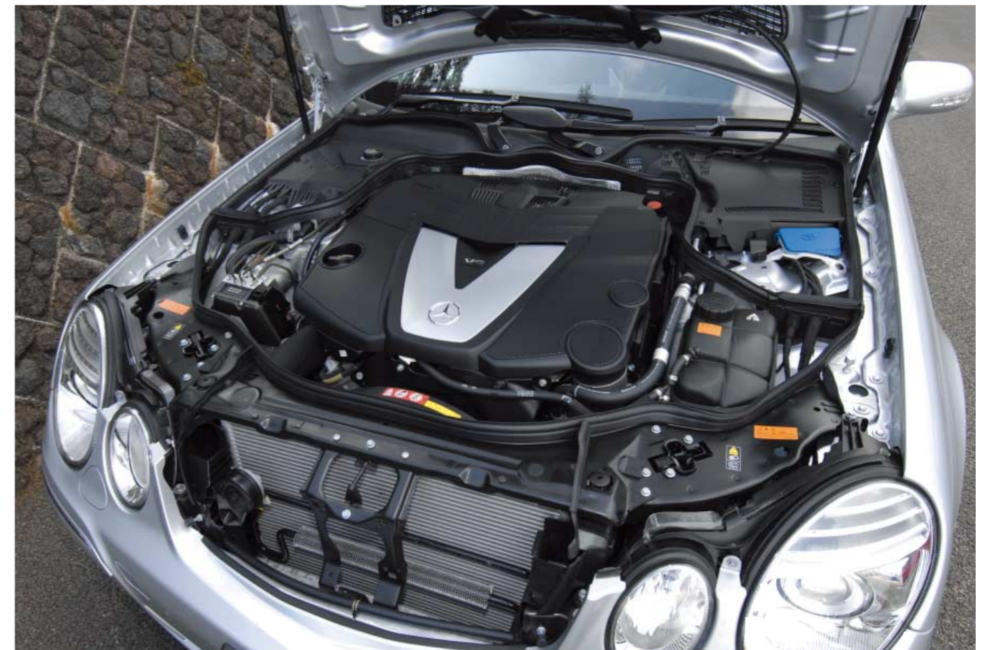
211ps/4000rpmの最高出力と55.1mkg/1600~2400rpmの最大トルクを生み出す2986ccV型6気筒インタークーラー付きディーゼルトターボ・ユニット。ピエゾインジェクターを使った超高压燃料噴射システムを持つメルセデスにとって第三世代のCDIである。パワフルでクリーンだが、現在販売されている“新長期規制”対応車は、さらに窒素酸化物の排出量が少ない。
