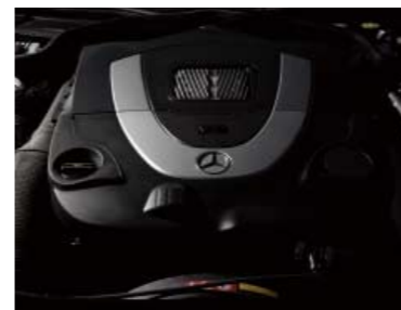
06年11月に行なわれたマイナーチェンジから加わった自然吸気の5.5ℓユニットは、国土交通省による「平成17年排出ガス基準50%低減レベル」認定を取得している。10・15モード燃費は7.1km/ℓ。 1870kg(前軸荷重:960kg/後軸荷重:910kg)を支えるタイヤは、前:255/40ZR18 後:285/35ZR18。このAMGマルチスポークアルミホイールと、同スタイリングパッケージは、SL550の標準装備。
