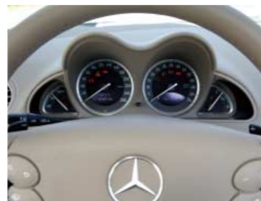
ATセレクターまわりに、ミラーやABCのモード切り替えスイッチ等を効率よく収めている。その後方に設置された大きなシルバーのスイッチはルーフ用。緊急時に立ち上がるロールバーを任意に操作できるスイッチも隠されている。 透過式の照明を使用することで、夜間時の視認性と上質感を両立しているメーターパネル。ステアリングホイール背面には“7G-TRONIC Sport”変速用パドル(左:シフトダウン/右:シフトアップ)を配置。
