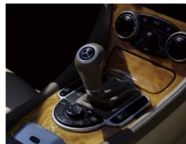
ATセレクターまわりに、ミラーやABCのモード切り替えスイッチ等を効率よく収めている。その後方に設置された大きなシルバーのスイッチはルーフ用。緊急時に立ち上がるロールバーを任意に操作できるスイッチも隠されている。 透過式の照明を使用することで、夜間時の視認性と上質感を両立しているメーターパネル。ステアリングホイール背面には“7G-TRONIC Sport”変速用パドル(左:シフトダウン/右:シフトアップ)を配置。
