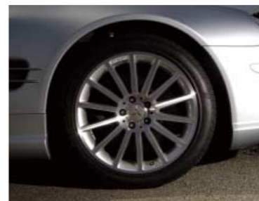
06年11月に行なわれたマイナーチェンジから加わった自然吸気の5.5ℓユニットは、国土交通省による「平成17年排出ガス基準50%低減レベル」認定を取得している。10・15モード燃費は7.1km/ℓ。 1870kg(前軸荷重:960kg/後軸荷重:910kg)を支えるタイヤは、前:255/40ZR18 後:285/35ZR18。このAMGマルチスポークアルミホイールと、同スタイリングパッケージは、SL550の標準装備。
