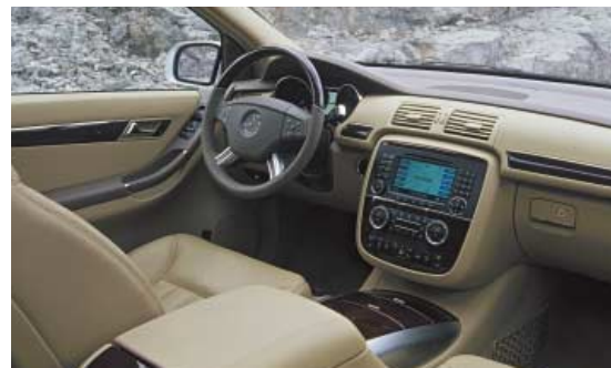
個性的なコックピットの中央に位置するマルチファンクションコントローラーには、助手席側のミラーに内蔵されたサイドビューカメラの映像が表示される。
