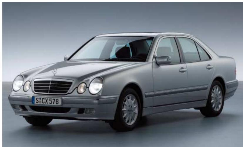
W124の後継車であるW210は1995年にデビュー。日本には95年10月から、2.3ℓ直4を積むE230、3.2ℓ直6のE320とE320アバンギャルドの3グレードが導入された。アバンギャルドは、専用アルミホイール、サスペンション、グリル、ガラス製スライディングルーフ、本革シート、バードアイ・メーブル・ウッドパネルなどを装備するグレードだ。
